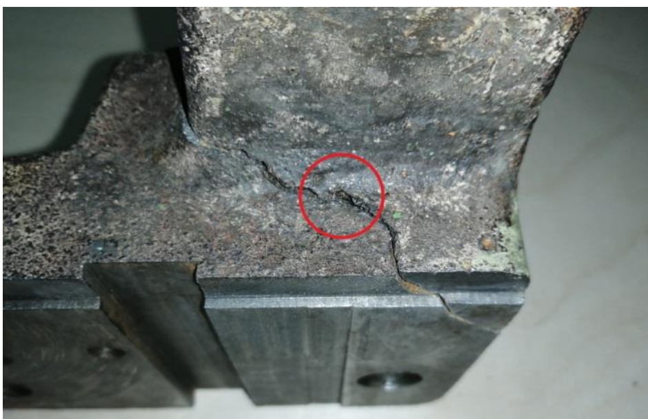
Рис. 6. Вероятная причина появления трещины – литейная раковина (выделена красным кругом)
