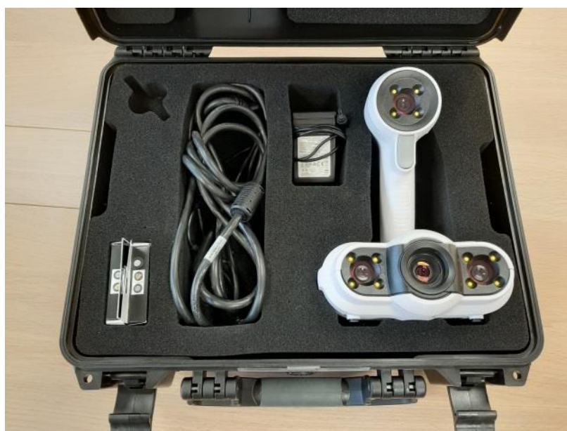
Рис. 2. Ручной 3D-сканер Creaform Academia 50
