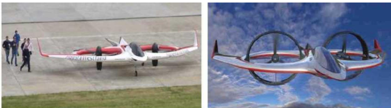
Рис. 6. а) электроконвертоплан «Project Zero», б) состояние роторов конвертоплана при горизонтальном полете
