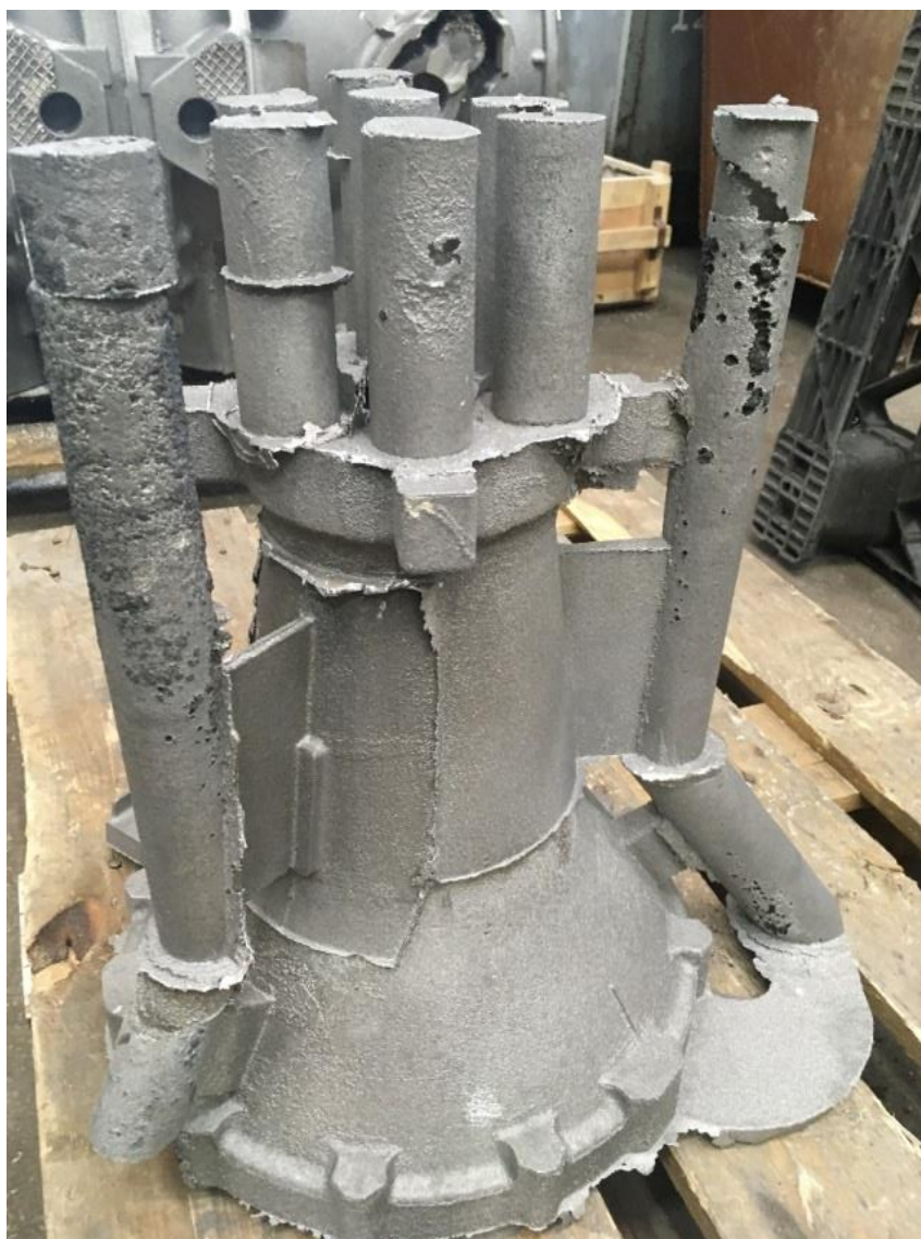
Рис. 10. Корпус с дефектами ЛПС и заливами
