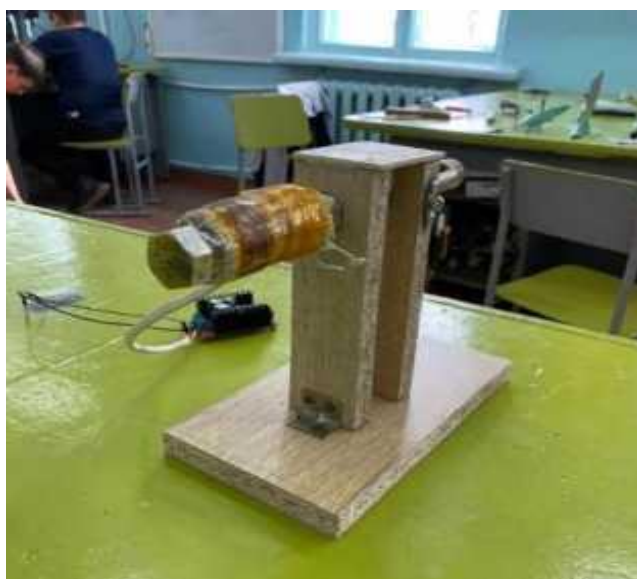
Рис. 3. Фото экструдера второго типа для получения мононити из гранул
