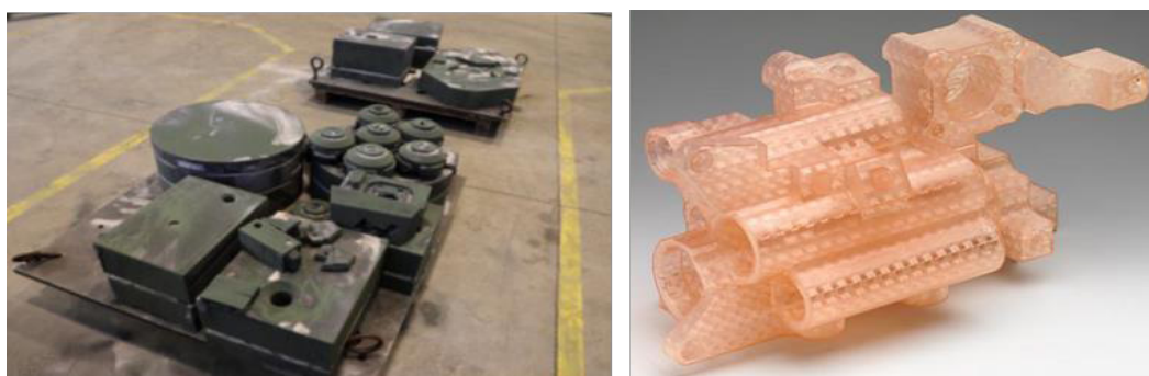
Рис. 3. Аддитивная оснастка ХТС – слева, и ЛВМ – справа
