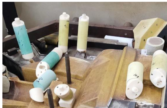
Рис. 9. Части литниковой системы (выпоры), материалом для которых может служить переработанный пластик (параллелепипед)
