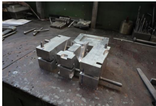
Рис. 3. Пример изготовления пресс-формы производства АО ААК «ПРОГРЕСС» и пресс-форма в разобранном виде (справа).
