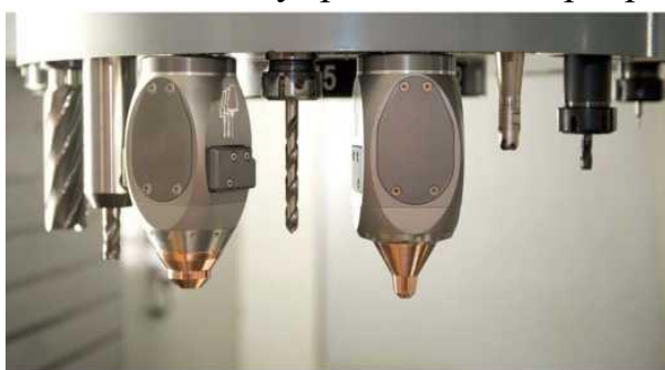
Рис. 1. Головки лазерного наплавления AMBIT, устанавливаемые в серийно выпускаемые металлорежущие станки и промышленные роботы
