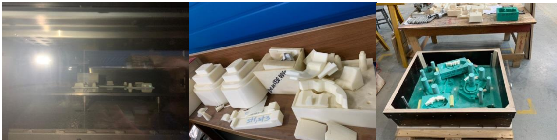
Рис. 5. Печать отъёмных частей на 3D-принтере и готовая форма с отъёмными частями, изготовленная на станке с ЧПУ.
