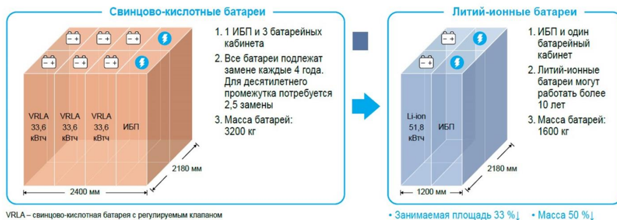
Рис. 1. Свинцово-кислотные батареи (слева) и литий-ионные батареи (справа)
