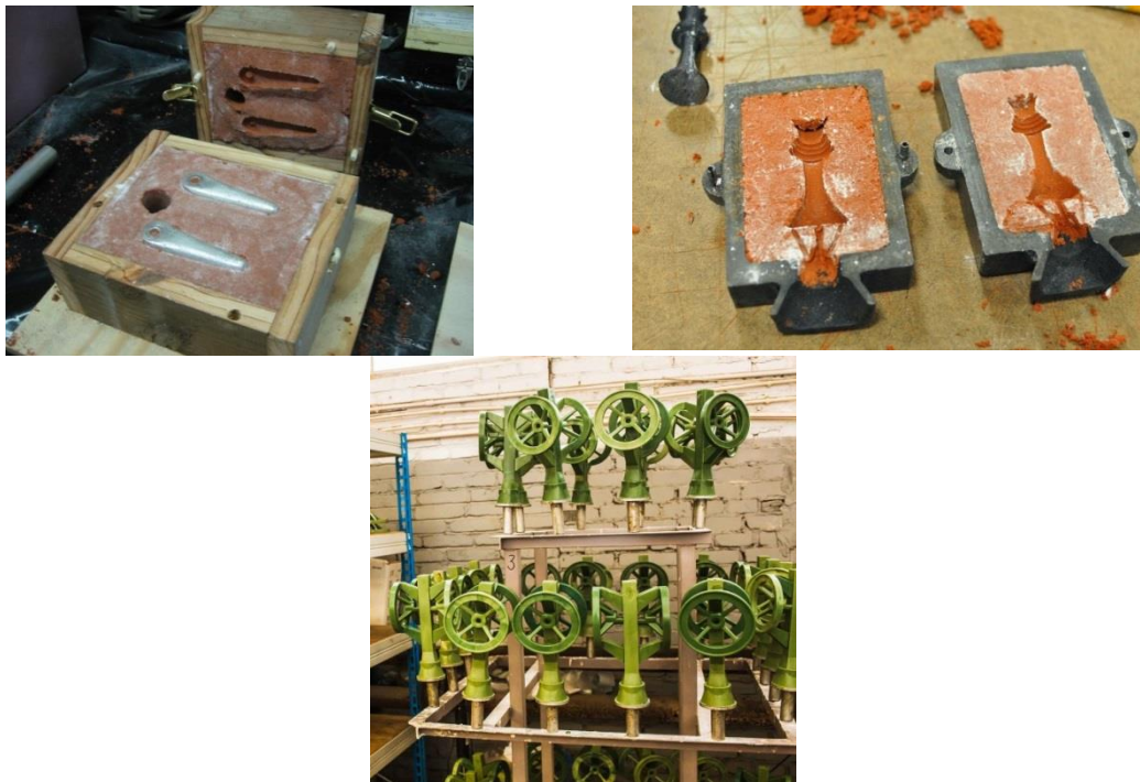
Рис. 4. Литье в песчано-глинистые формы
