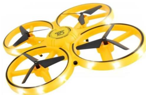
Рис. 10 – кольцевая несущая система
