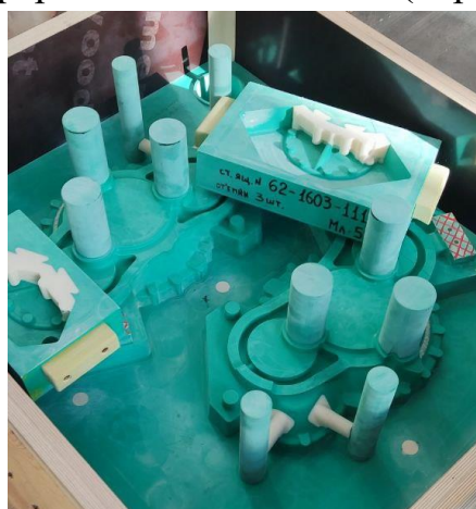
Рис. 10. Части литниковой системы (выпоры), материалом для которых может служить переработанный пластик (цилиндр)
